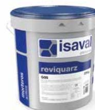
Mortero acrílico mineral de grano fino homogéneo para la impermeabilización de fachadas e interiores. Aplicación a llana o pistola de pastas densas. Imitación de acabado mortero monocapa. No cuartea en capa gruesa. Con conservante antimoho (para película).
